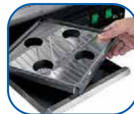
Емкость для воды, используемой для поддержания повышенного уровня влажности во внутреннем объеме.
